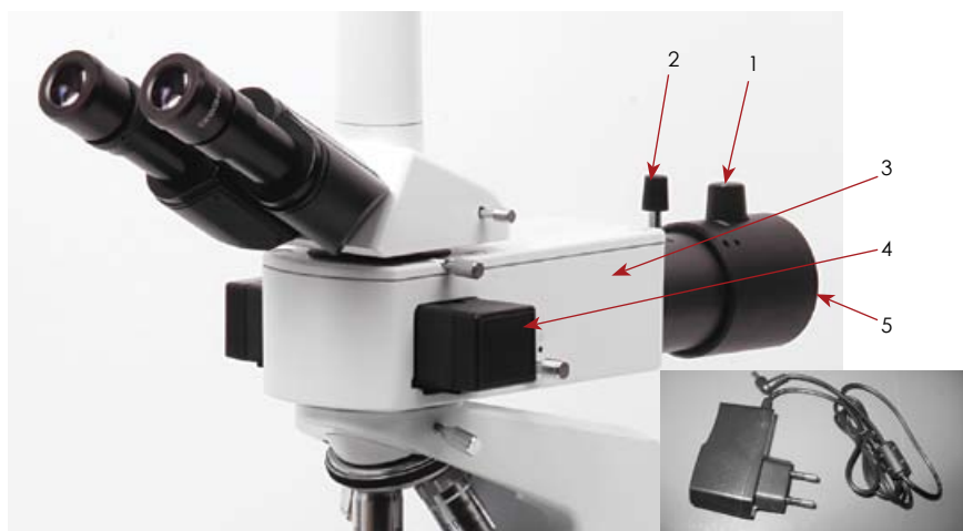
Рис. 4. Люминесцентный светодиодный осветитель:
